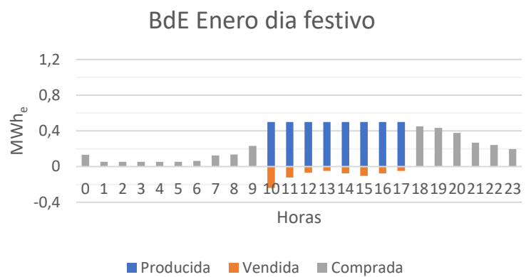
Figura 7.4. Balance de energía para los días tipo laborable y festivo de enero en función de las horas
