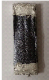
Fig 21. Ejemplo de lámina preparada para ser caracterizada termoeléctricamente
