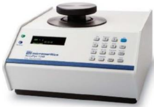
Fig 39. Equipo ACCUPYC II
