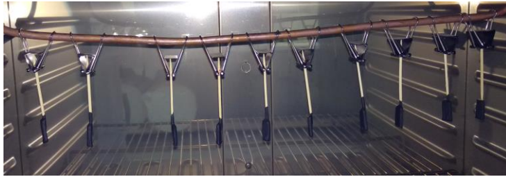
Fig 34. Láminas colocadas en estufa para la etapa de secado del recubrimiento
