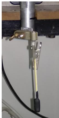
Fig 33. Lámina una vez extraída de la suspensión
