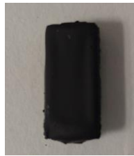
Fig 35. Lámina final recubierta con la suspensión, una vez retirado el esparadrapo y el palillo
