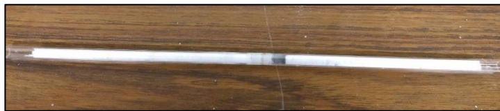
Figura 9. Reactor de Cuarzo con lecho fijo de \text{Sr/La}_2\text{O}_3 (antes de reacción)
