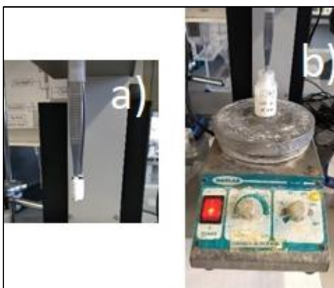
Figura 6. a) colocación del monolito en las pinzas del dipcoater; b) inmersión del monolito con el dipcoater en un slurry con agitación
