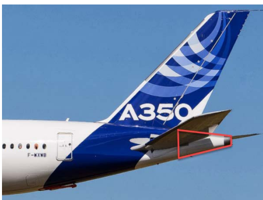
Vista lateral izquierda del A350XWB indicando la ubicación prevista para la instalación del DCVDR en la S19.1
