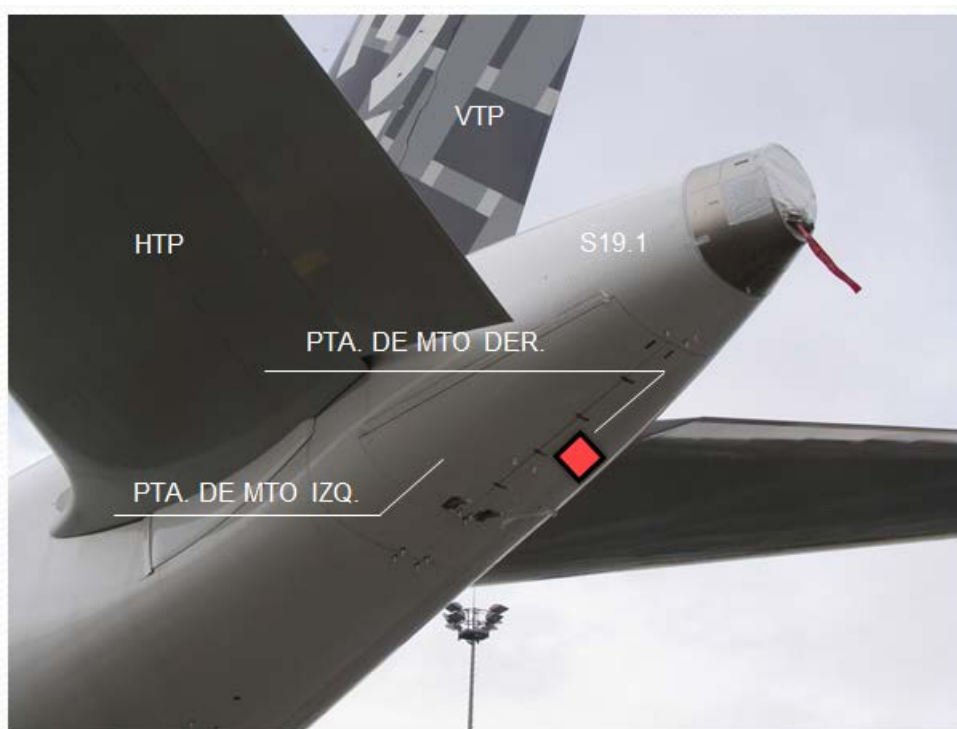
Representación esquemática de la posición del DCVDR (en rojo) en la S19.1 en la puerta de mantenimiento derecha de la S19.1
