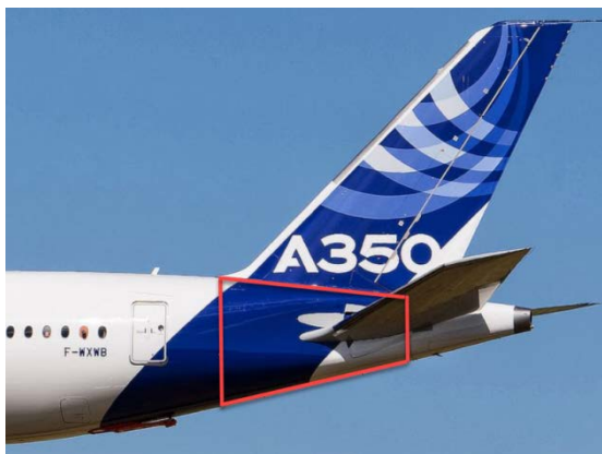
Vista lateral izquierda del A350XW indicando la ubicación prevista para la instalación del DCVDR en la S19
