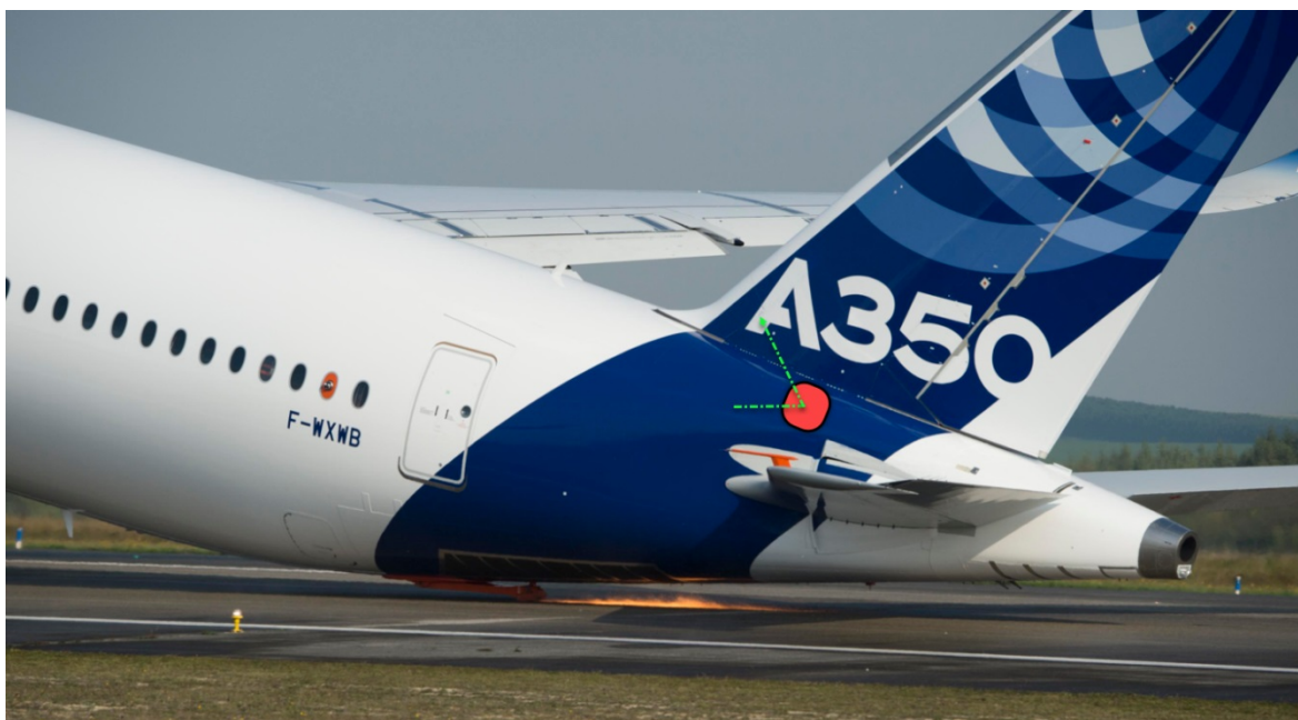
Representación esquemática de la posición del DCVDR (en rojo) en la S19 entre el VTP y el HTP con un ángulo de eyección intermedio para salvar ambas estructuras
