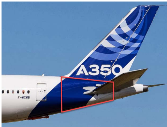
Vista lateral izquierda del A350XW indicando la ubicación prevista para la instalación del DCVDR en la S19
