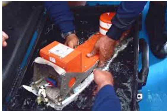
Ilustración 16. Cajas negras rescatadas del vuelo QZ8501 de Air Asia.
