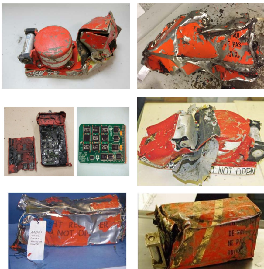
Ilustración 11. Cajas negras dañadas después de accidentes.
