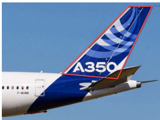
Vista lateral izquierda del A350XWB indicando la ubicación prevista para la instalación del DCVDR en el VTP
