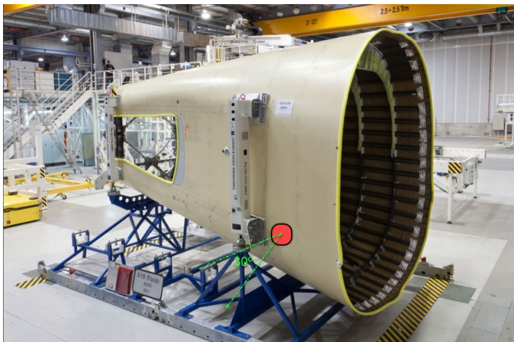
Representación esquemática de la posición del DCVDR (en rojo) por debajo de la zona del HTP y con los aproximadamente 30° del ángulo de eyección hacia abajo
