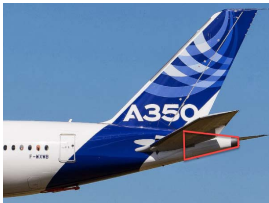
Vista lateral izquierda del A350XW indicando la ubicación prevista para la instalación del DCVDR en la S19.1
