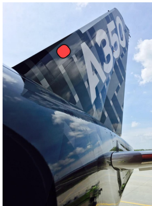
Representación esquemática de la posición del DCVDR (en rojo) en el borde de ataque del VTP
