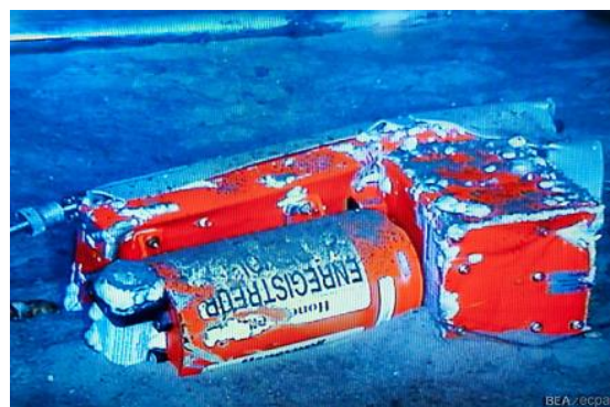
Ilustración 13. Cajas negras rescatadas del vuelo AF447 de Air France.
