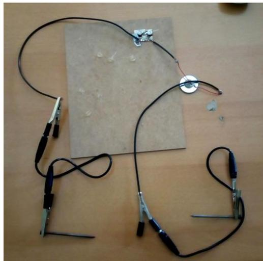
Imagen 6. Circuito musical utilizado para demostrar la conductividad y no conductividad de determinadas sustancias en función de su enlace químico.
