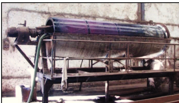
Figura 23. Tromel utilizado para eliminar impurezas (Destilería San Valero S. Coop., 2012).
