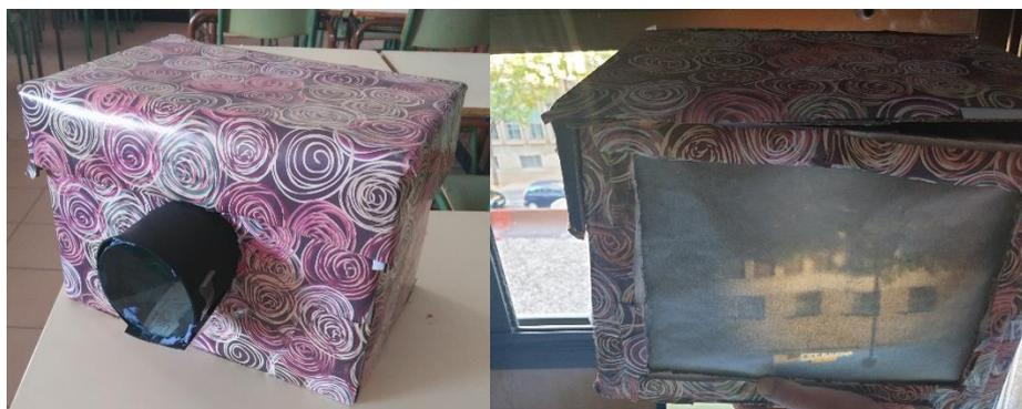
**Figura 8.** Cámara oscura construida (izquierda) e imagen invertida que se forma (derecha).
