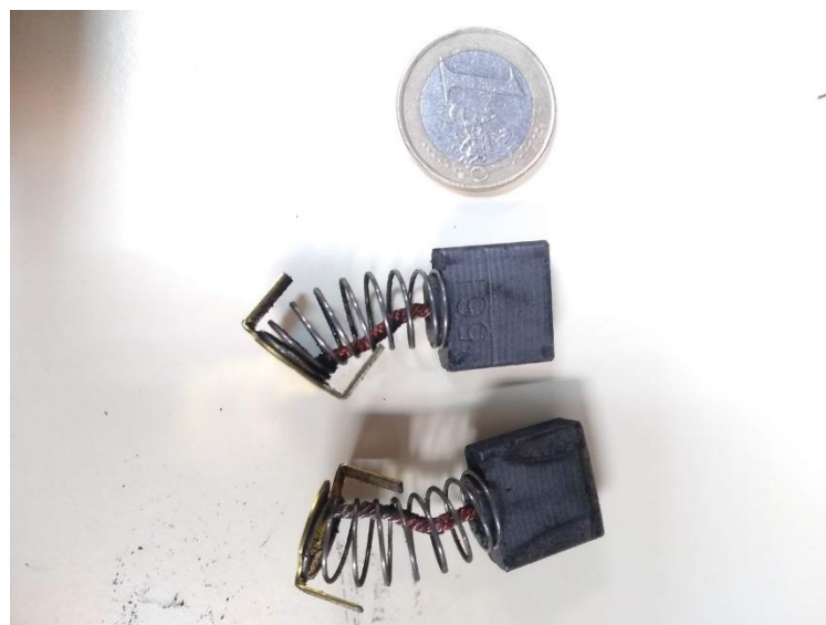
Ilustración 65 - Estado de las escobillas del motor de imanes permanentes que accionan la cinta ergométrica. Se utiliza una moneda como referencia de tamaño.
