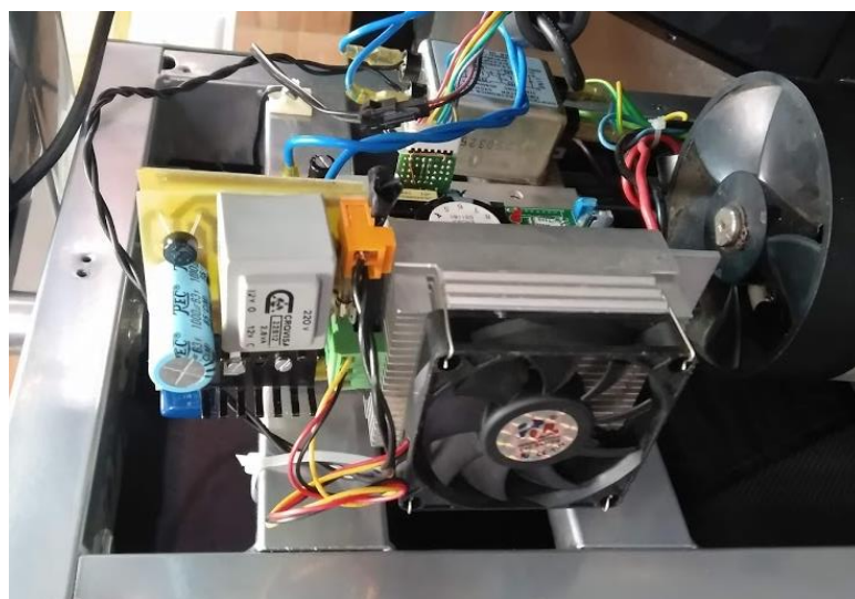
Ilustración 90 - Sistema de refrigeración en su ubicación final.
