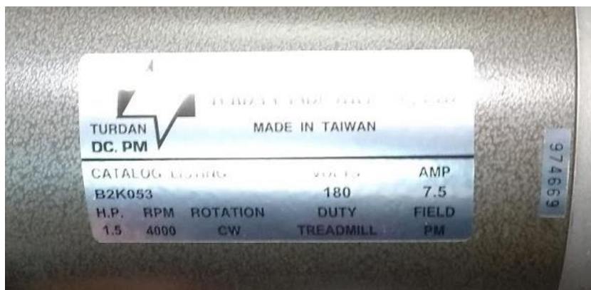
Ilustración 61 - Etiqueta de servicio del motor eléctrico de corriente continua de imanes permanentes (PMDCM por sus siglas en inglés) que propulsa la banda de rodadura.
