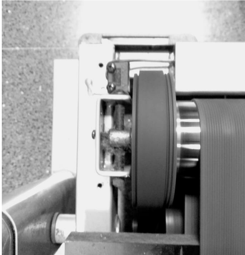
Ilustración 46 - Detalle de la rueda acanalada que transmite la potencia al rodillo, el mecanismo de varillas roscadas y en la parte superior se puede ver el sensor de frecuencia angular.
