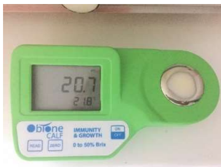
Figura 5. Refractómetro digital Obione calf con una muestra de calostro en el sensor y su respectiva medida en Brix.
