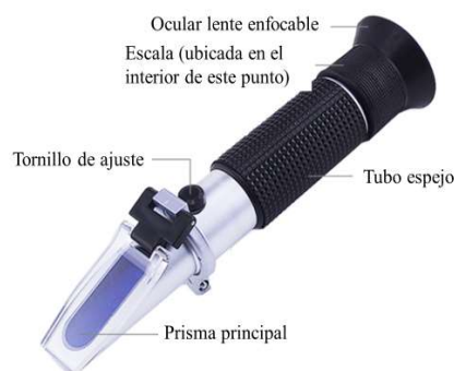
Figura 2. Refractómetro con la identificación de las partes que lo constituye. Fuente: ( https://www.tplaboratorioquimico.com/laboratorio-quimico/materiales-e-instrumentos-de-un-laboratorio-quimico/refractometro.html ).
