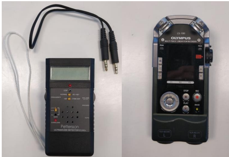
Figura 20: Detector de ultrasonidos Peterson D 240x y grabadora Olympus Multi-track linear pcm.
