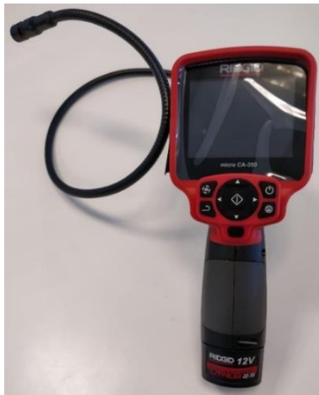
Figura 19: Cámara endoscópica Ridgid micro CA-350 empleada para este tipo de inspección.
