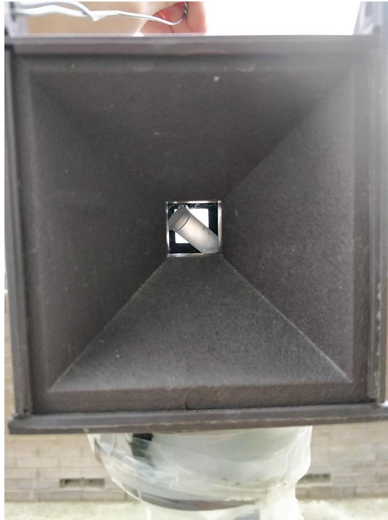
Figura 34: Interior de la trampa G, a la vista feromona atrayente para procesionaria del pino.
