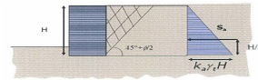
Figura 39: Diagramma della spinta attiva di un terreno non coesivo su una parete verticale liscia
