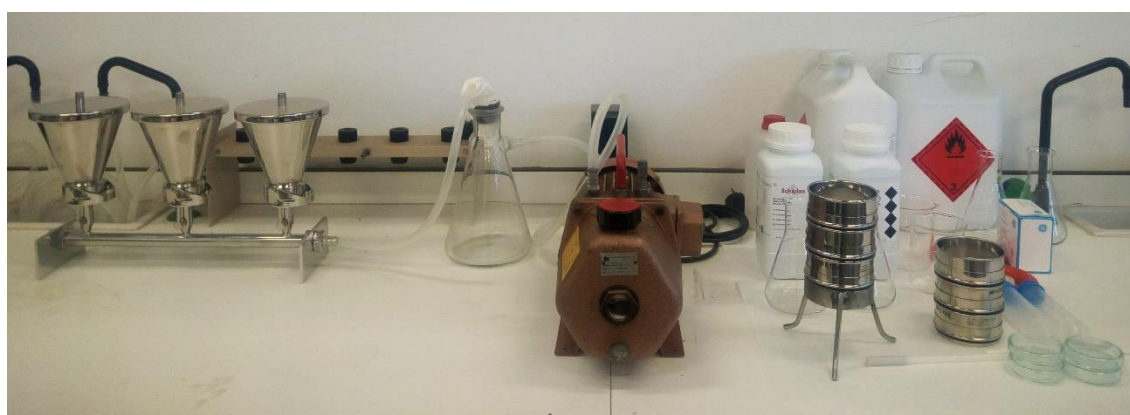
Figura 13. Instrumental utilizado para la extracción de esporas: rampa de filtrado con bomba de vacío (izquierda) y nido de tamices (derecha).
