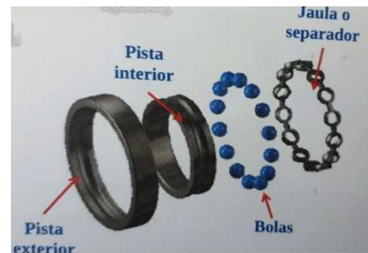
Ilustración 27. Partes de un rodamiento.
