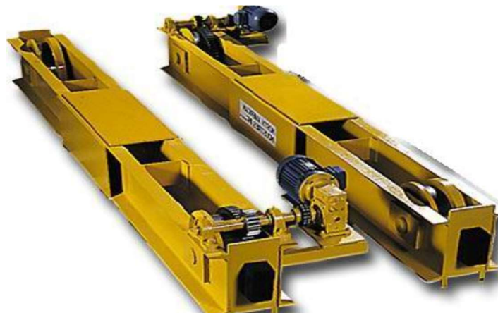
Ilustración 57. Sistema de traslación del carro, partes 2.
