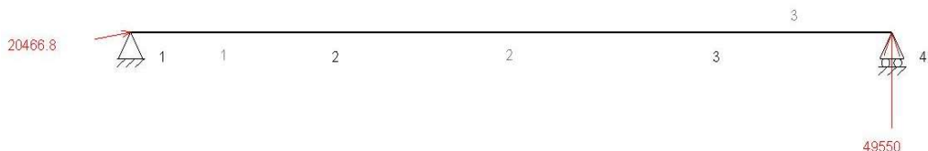
Ilustración 121. Reacciones en los puntos 1 y 4 del eje C, plano XY.
