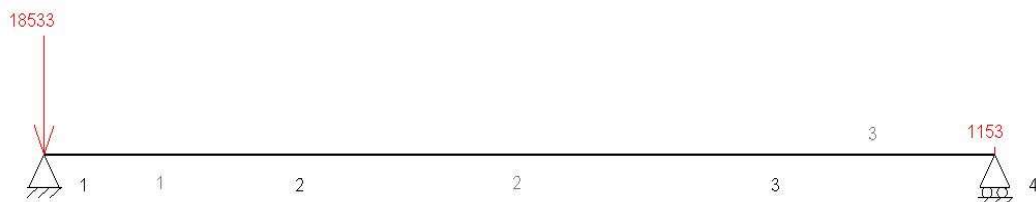
Ilustración 118. Reacciones en los puntos 1 y 4 del eje A, Plano XZ.
