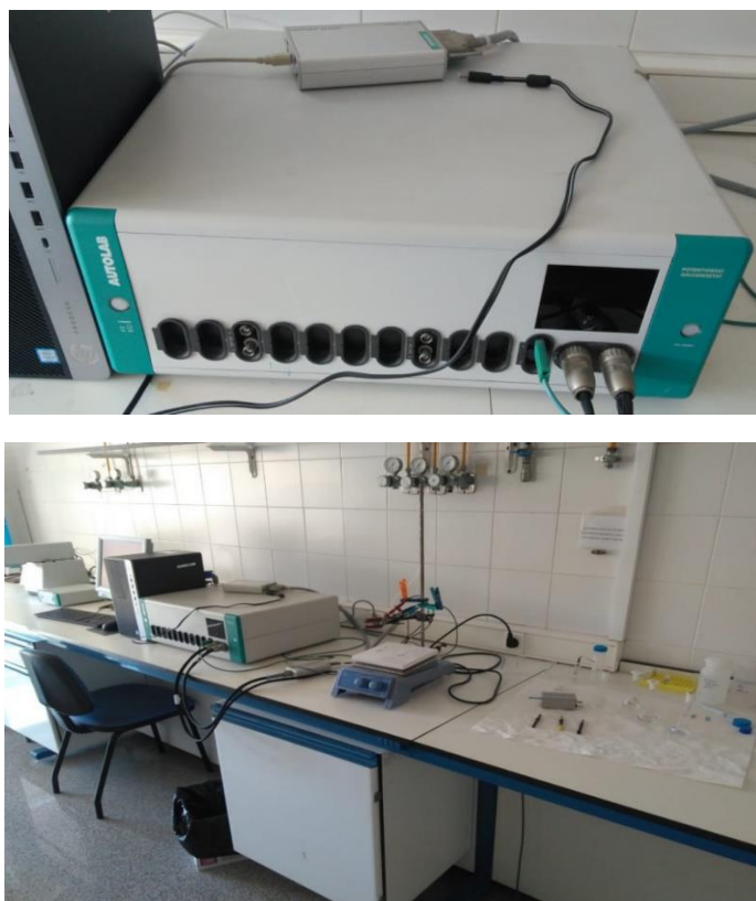
Figura 2. Lugar de trabajo: Potenciostato AUTOLAB PGSTAT12 controlado por ordenador, cubeta voltamétrica y electrodos de trabajo.
