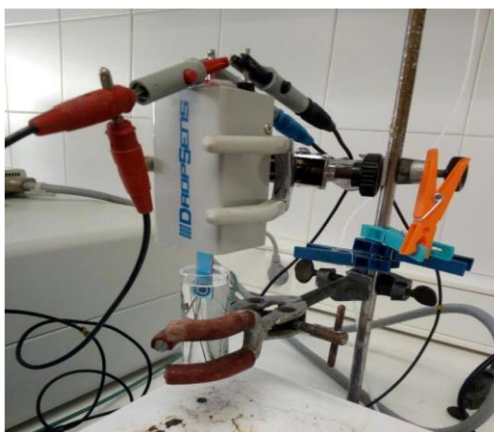
Figura 7. Electrodo serigrafiado de diamante dopado con boro en la cubeta voltamétrica.
