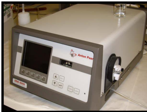
Figura A1: Analizador de densidad y velocidad de propagación del sonido Anton Paar DSA-5000.
