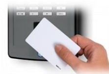
Ilustración 10. Tarjeta de proximidad RFID para identificación y acceso. (Figura). Extraído de: consumiblestpv.com
