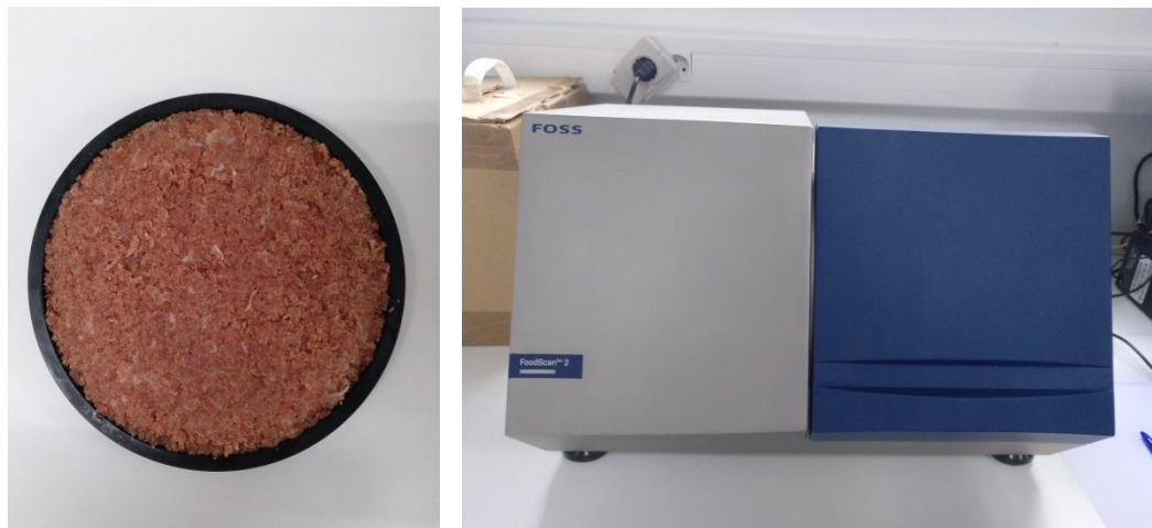
Figura 10. Determinación de composición química del jamón mediante NIR.
