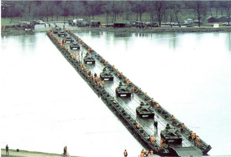
*Figura 1: Puente flotante MAN. Fuente: CIA de puentes flotantes.*
