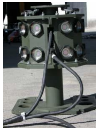
Figura 14. LDU, adaptador y soporte
