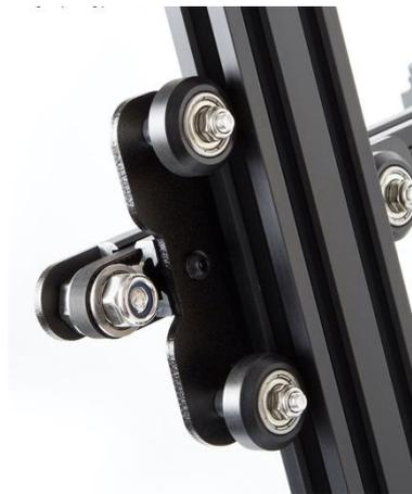
*Ilustración 13. Sistema V-slot Wheel*
