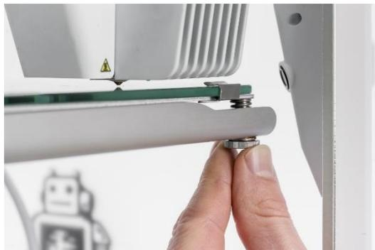
*Ilustración 44. Ajuste manual de la superficie de impresión.*
