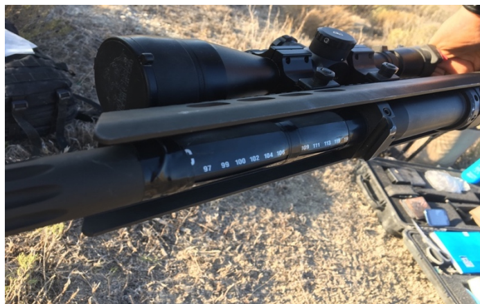
Figura 15. Termómetros adhesivos en el cañón del fusil
