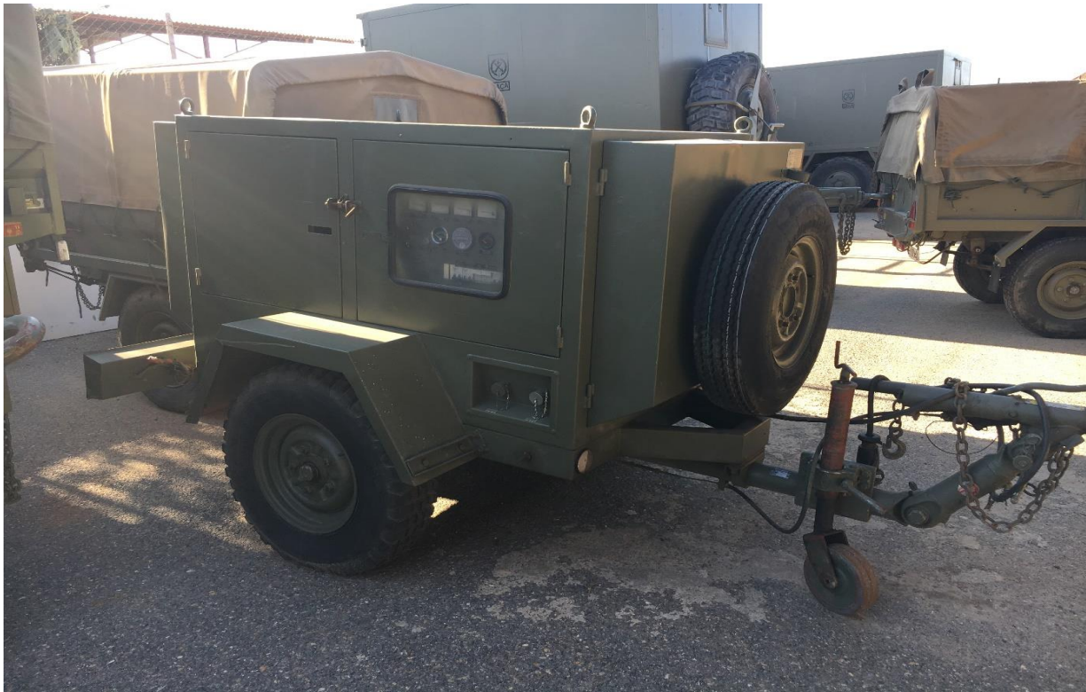
Figura 4. Grupo electrógeno del GACALEG.
