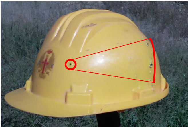
Figura 13 Casco con impacto de munición Fuente: Autor
