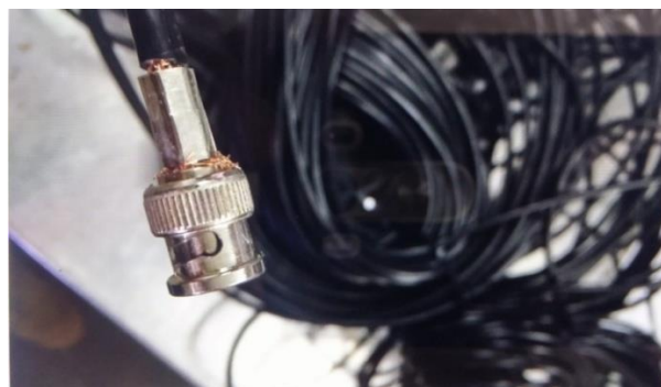
Ilustración 6. Cable coaxial RG-59 con entrada BNC
