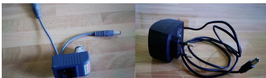
Ilustración 9. Balum (izquierda), cable de corriente (derecha)
