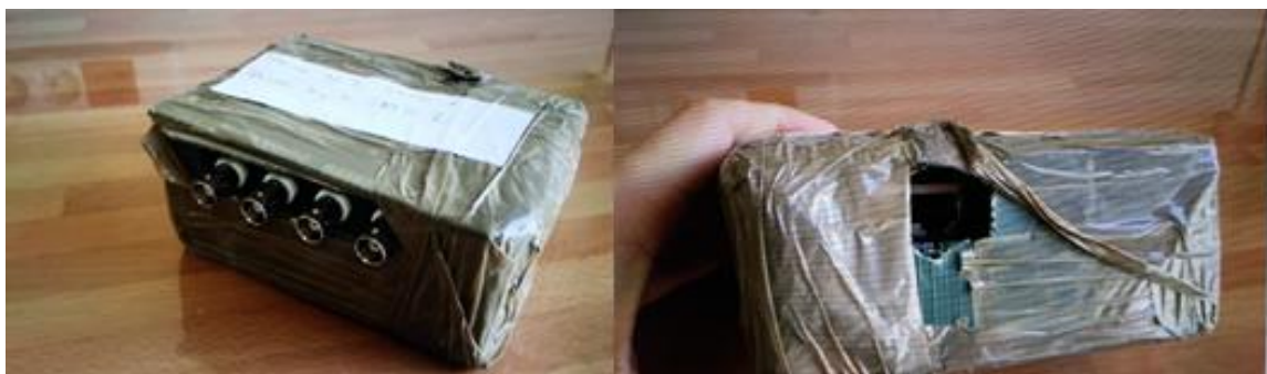
Ilustración 7. Conector current-line. Entradas BNC (izquierda), entrada RJ45 (Derecha)
