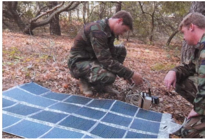
Figura 7. Recarga de baterías mediante panel solar.
