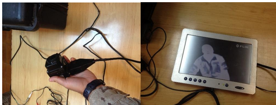
Figura 20. Cámara térmica Flir conectada y resultado de la visualización en pantalla táctil.
