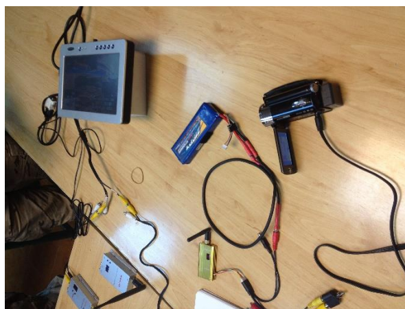
Figura 18. Sistema de vigilancia creado con cámara Panasonic, pantalla táctil y transmisión en tiempo real por Transmisores analógicos.
