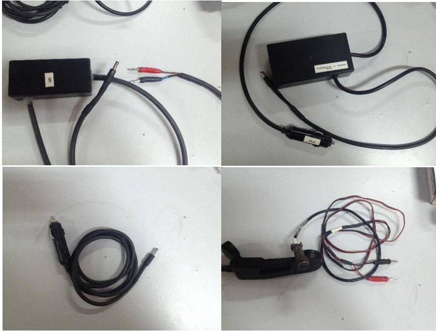
Figura 13. Conectores de diversos tipos, con los dos polos para conectar a la fuente y extremos varios (mechero, USB, etc.), para sistema de vigilancia montado sobre vehículo y en tierra firme. [17]
