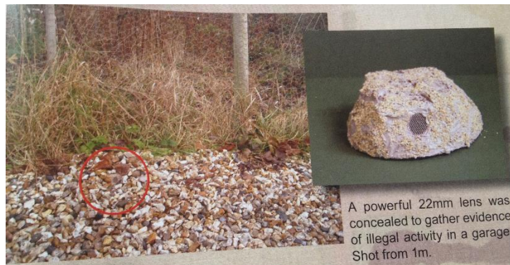
Figura 5. Sensor oculto en carcasa enmascarada. También podrían ocultarse bajo el agua.
