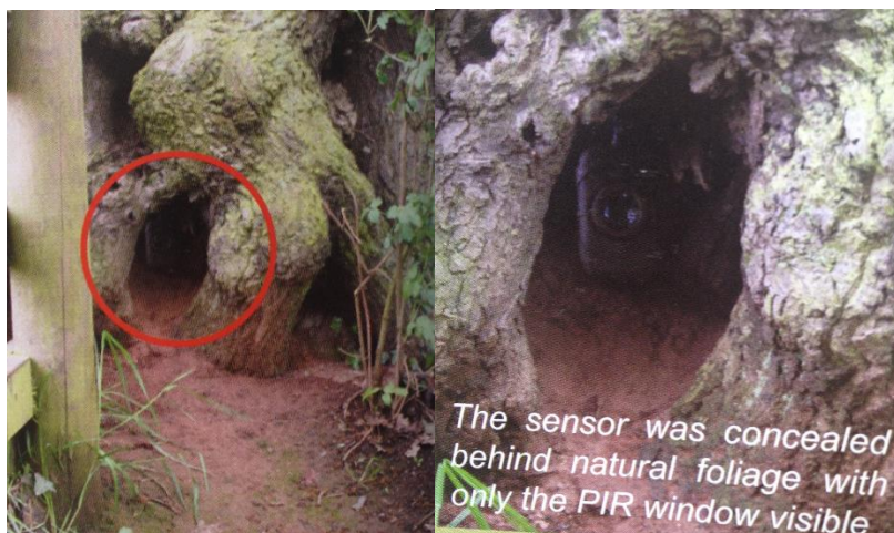
Figura 10. Sensor y transmisor ocultos empleando el propio entorno como soporte físico.
