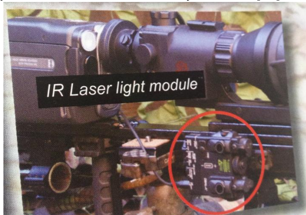
Figura 14. Detalle de puntero láser para guiar el sensor.
