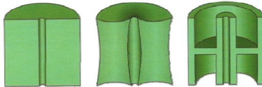
Figura i.2. Una pieza gruesa (izquierda) puede dar lugar a una contracción excesiva y alabeo (centro); un diseño alternativo recomendable con espesor uniforme (derecha)
