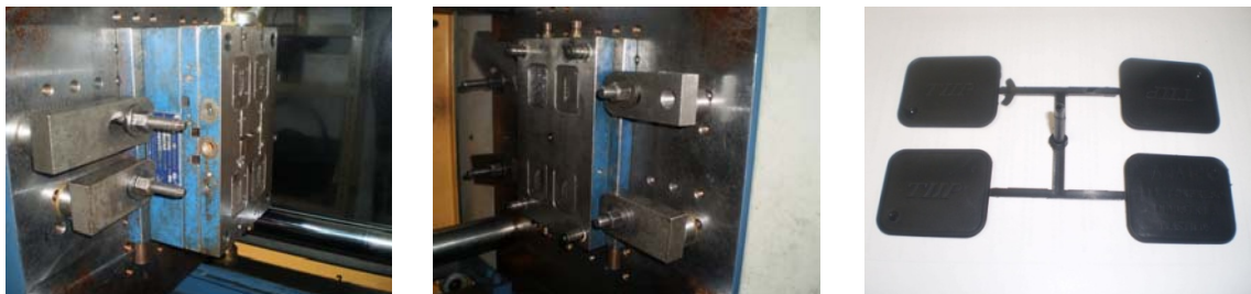
Figura iii.13. Cavidades del molde y pieza de cuatro figuras producida
