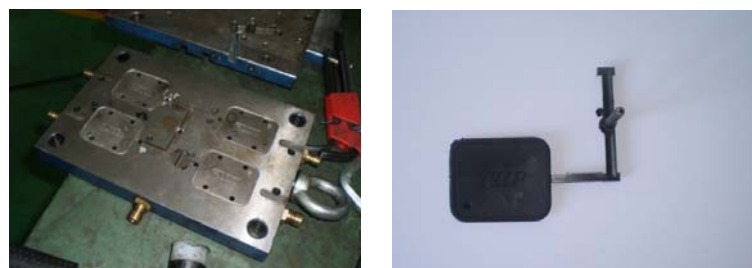
Figura iii.14. Giro del canal para producir pieza de una figura (izquierda) y pieza de una figura producida (derecha)
