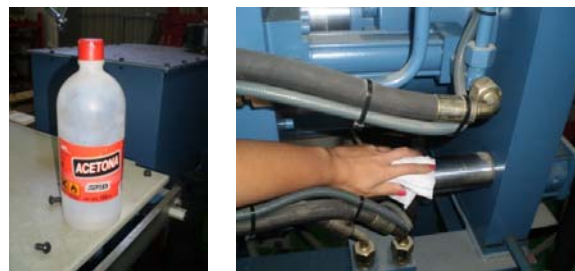
Figura iii.3. Limpieza con acetona
