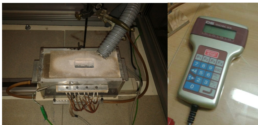
Figura 35: Mesa de desplazamiento controlado con horno de resistencias (izquierda). Control desplazamiento de la mesa (derecha)
