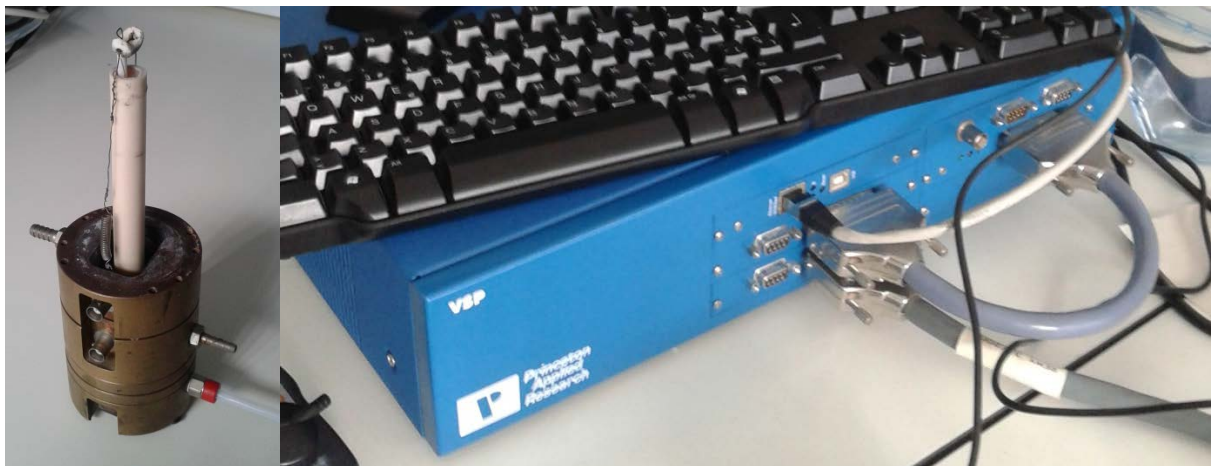
Figura 545: Equipo empleado en EIS. Celda de medición (izquierda). Potenciostato VSP (derecha)
