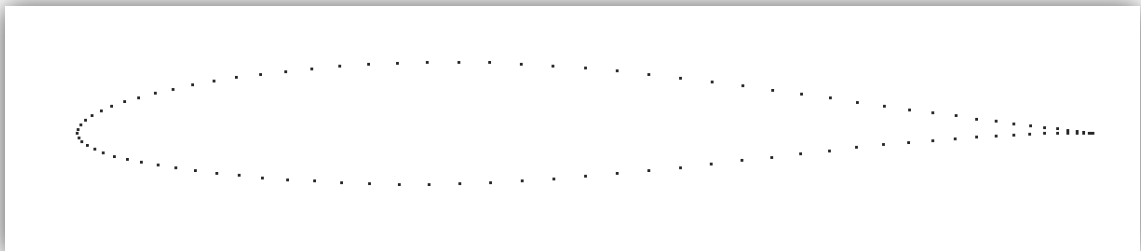
Imagen 5.4. Puntos que definen el perfil NACA 63 212
