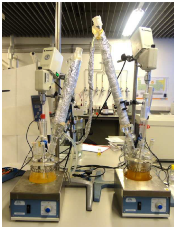
Figura A-V. 1- Instalación para la producción de biodiésel
