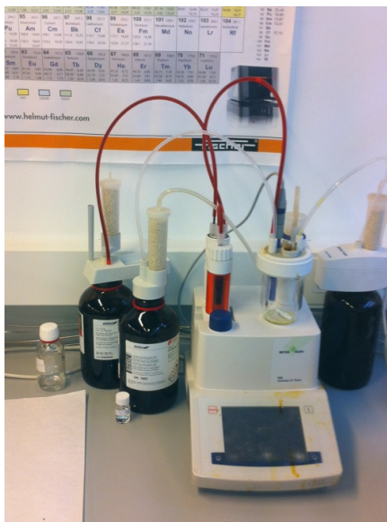
Figura A-V.9- Valorador Karl-Fischer para la determinación de la cantidad de agua
