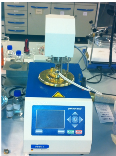
Figura A-V.8- Equipo para la medida del punto de inflamación (Flash Point)
