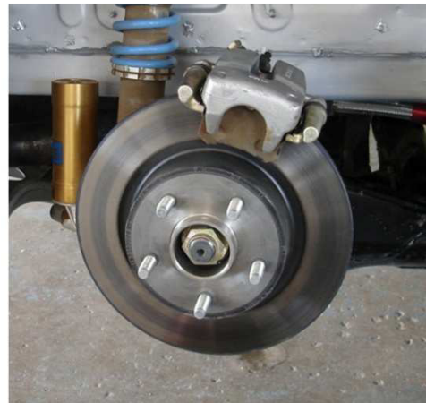
Ilustración 30 - Discos de freno y pastillas instalados en el tren delantero y trasero respectivamente
