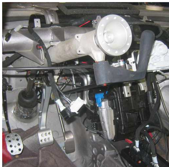
Ilustración 28 - Soporte de columna de dirección ya instalado en el vehículo
