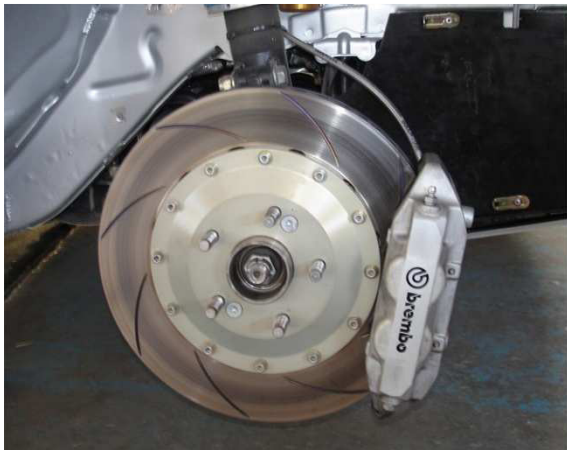
Ilustración 30 - Discos de freno y pastillas instalados en el tren delantero y trasero respectivamente
