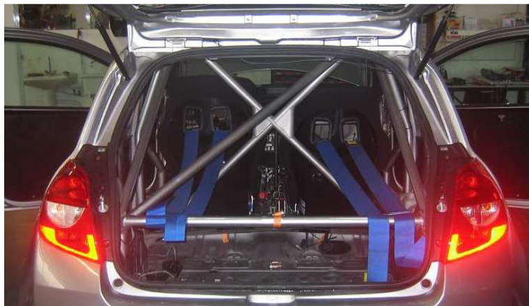
Ilustración 38 - Detalle sujeción arnesees al arco de seguridad
