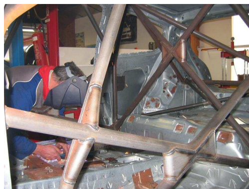
Ilustración 45 - Refuerzo de la carrocería mediante soldadura
