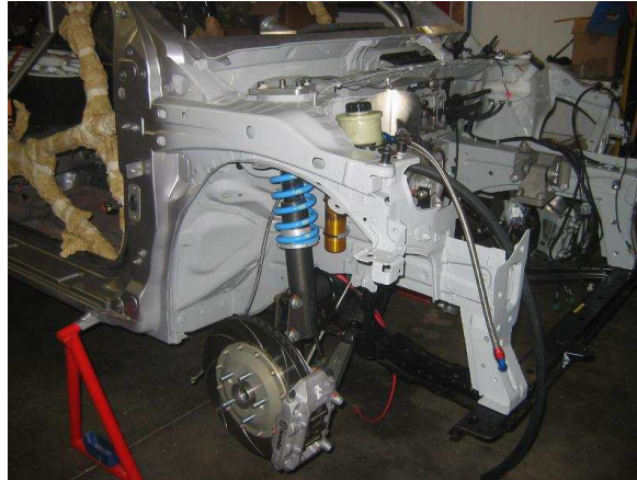
Ilustración 47 - Tren delantero en proceso de montaje
