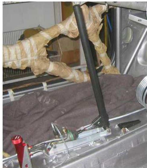
Ilustración 32 - Freno de mano hidráulico vertical
