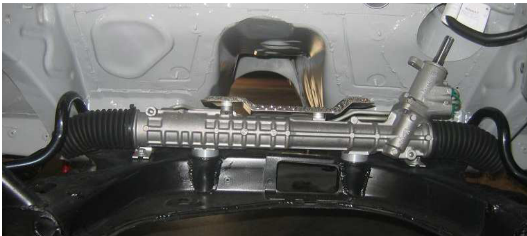
Ilustración 25 - Cremallera de dirección Clio R3
