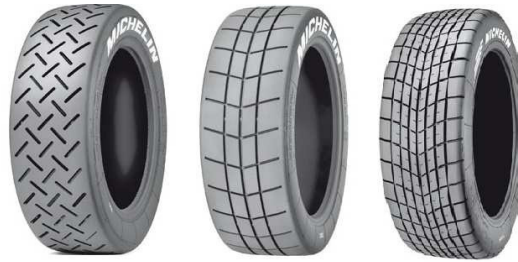
Ilustración 19 - Neumáticos para asfalto: seco, mixto y mojado
