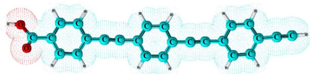
Figura 3.24. Estructura Química del ácido 4-[4'-(4''-etinilfeniletinil)-feniletinil]-benzoico (HOPEA).
