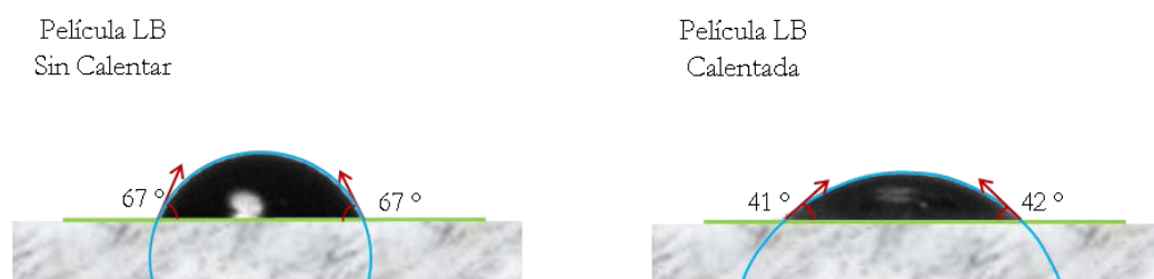
Figura 4.23. Medida del ángulo de contacto para una película de G-PEA transferida sobre un sustrato de vidrio sin calentar y calentada.
