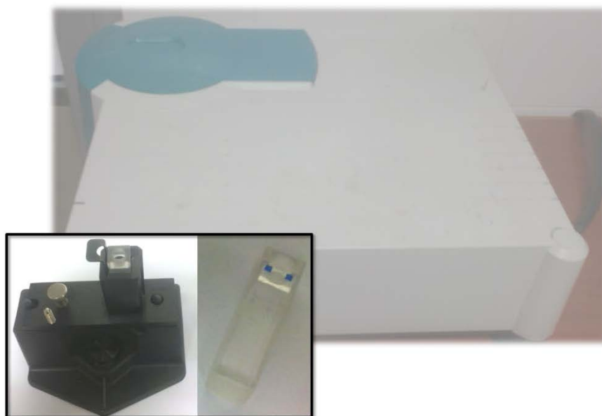
Figura 2.14. Espectrofotómetro de absorción UV-vis. Soporte para muestras (cubeta y sustrato de cuarzo).
