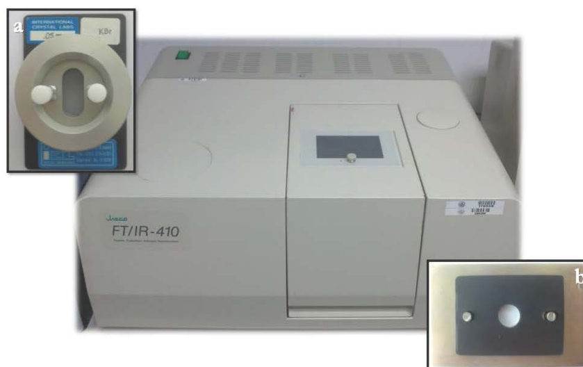
Figura 2.15. Espectrofotómetro de absorción Infrarroja con transformada de Fourier. Soporte para muestras: (a) líquidas y (b) sólidas.
