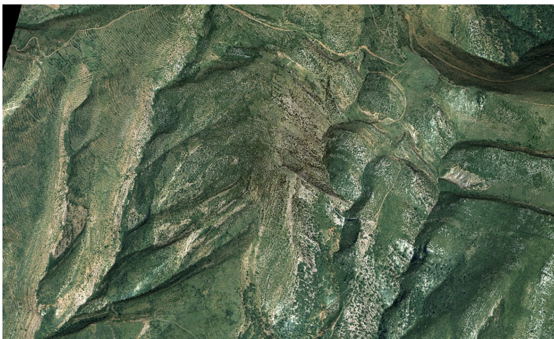
Figura 3. Detalle de la zona del perfil de Santa Marina y estaciones BG (Bagüeste) en el Modelo Digital del Terreno construido a partir de la malla de elementos finitos creados y las ortofotos (1:5.000), Microstation software.
