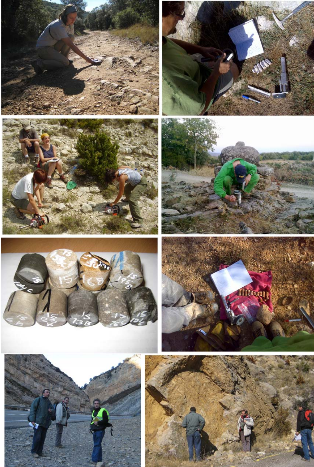
Figura 33. Tareas de perforación, orientación in situ y adquisición de muestras con fines paleomagnéticos y bioestratigráficos así como toma de datos de campo y tareas de preparación de especímenes en el laboratorio.
