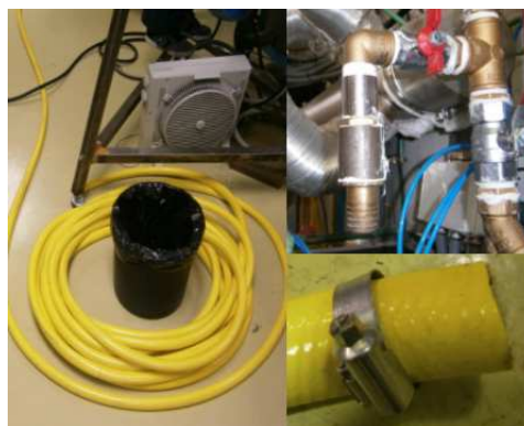
Figura 3.17: Tubo flexible. Abrazadera y toma de aire comprimido
