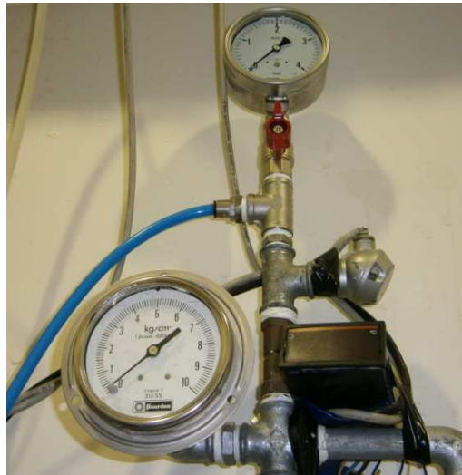
Figura 3.3: Manómetro de mayor rango (abajo) y manómetro de menor rango (arriba)
