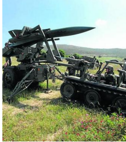
Ilustración 23. Imágenes reales de lanzador de misiles HAWK con misiles de guerra y cargador de misiles HAWK con misiles de instrucción.
