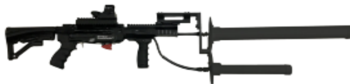
Figura 16 – Sistema Jamming: Battelle Drone Defender [21]
