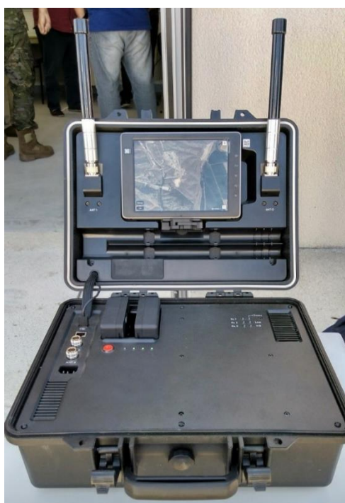
Figura 18 – DJI AEROSCOPE usado por el ET. [20]
