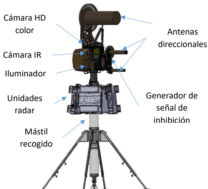
Ilustración AUDES 1 – Partes del sistema AUDES Blighter
