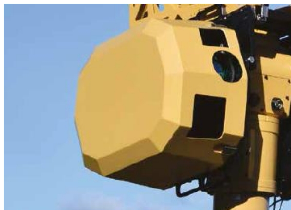
Figura 21 – Cámaras HD e IR, sistema de identificación del AUDS Blighter [24]
