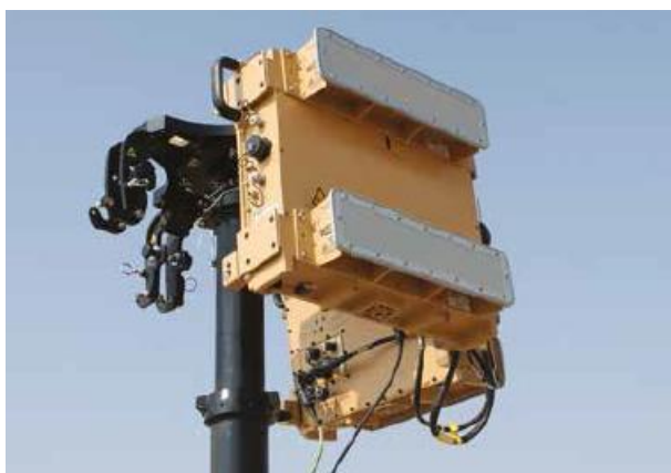
Figura 20 – Radar, sistema de detección del AUDS Blighter [24]
