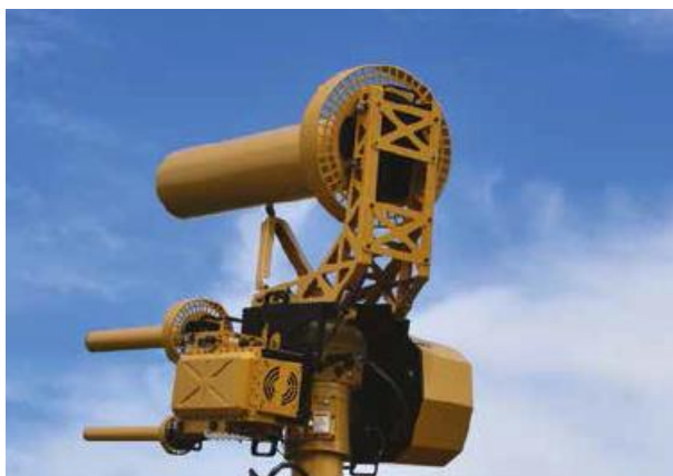
Figura 24 – Antenas de inhibición, sistema de neutralización del AUDS Blighter [24]
