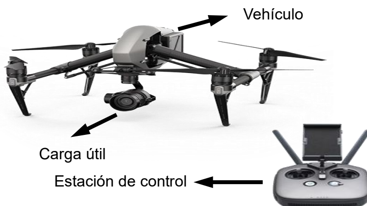
Figura 1 – Partes de un RPAS [8]
