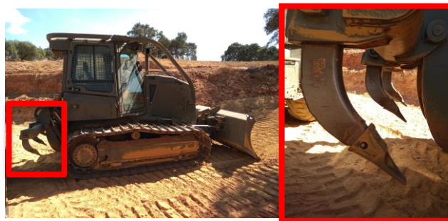
Ilustración 4. Detalle del perfil de los dientes de la empujadora F.106.6 Fuente: propia
