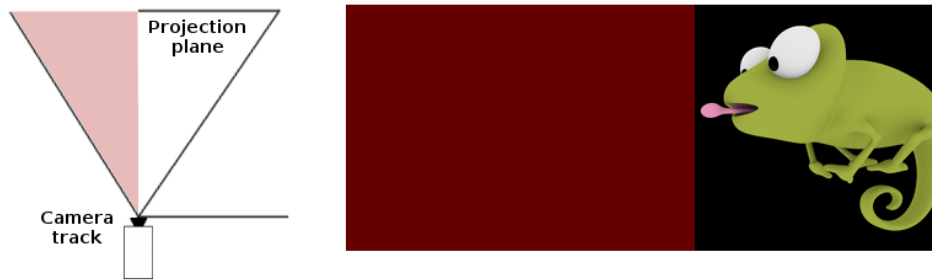
Figura 4.5: La cámara se caracteriza por un campo de visión más ancho. El área innecesaria de la imagen es descartada en la imagen de la derecha.
