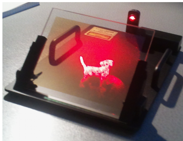
Figura 1.7: El perro es reconstruido aplicando un haz láser de referencia al holograma. Holograma presentado por el Dr. Kenji Yamamoto en la 3D Media Training School, Tampere, 2012.
