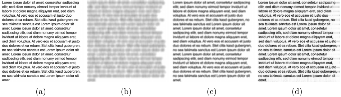
Figura 5.2: a) Imagen de texto original. Escalado iterativo (zoom-in&zoom-out) 75 veces, factor \sqrt{2} b) algoritmo bilinear, c) algoritmo bicubic, d) algoritmo Fast DCT.
