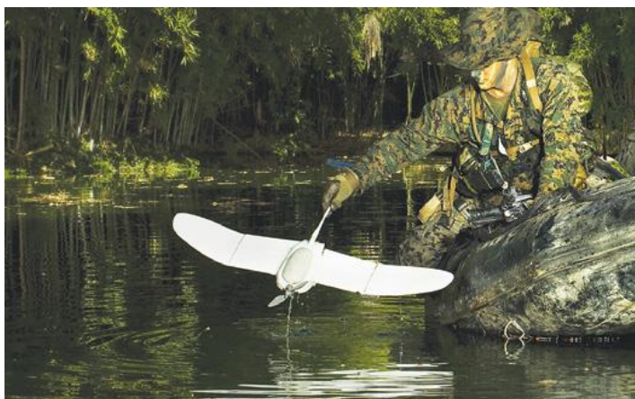
Ilustración 6. Recuperación mediante aterrizaje en agua del WASP. Fuente [14]
