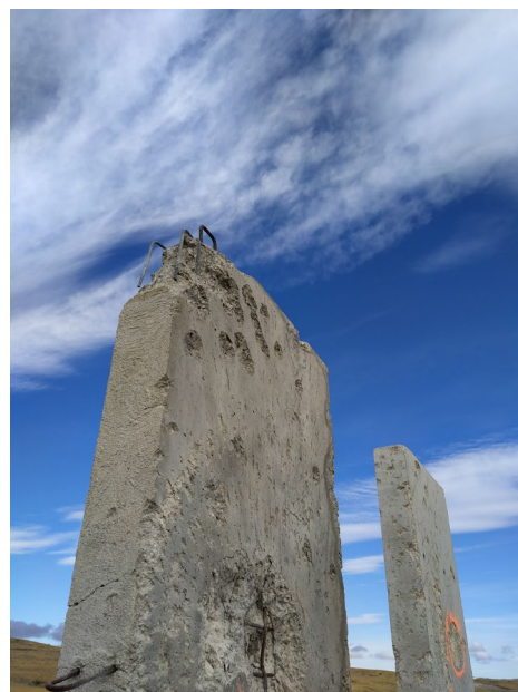
Figura 40. T-Wall después de impacto por proyectil de C-90-CR-BR (M3), elaboración propia.
