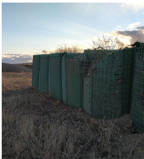
Figura 37. Hesco antes de impacto por proyectil de C-90-CR-BR (M3), elaboración propia.
