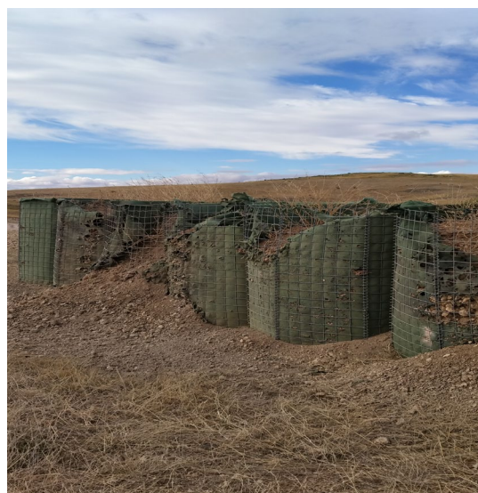
Figura 38. Hesco después de impacto por proyectil de C-90-CR-BR (M3), elaboración propia.
