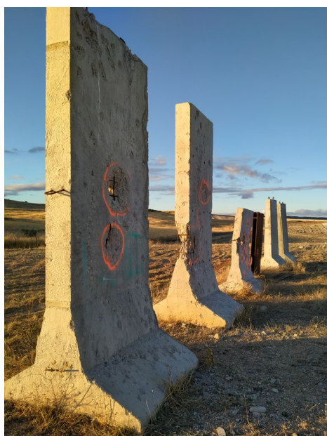
Figura 39. T-Wall antes de impacto por proyectil de C-90-CR-BR (M3), elaboración propia.
