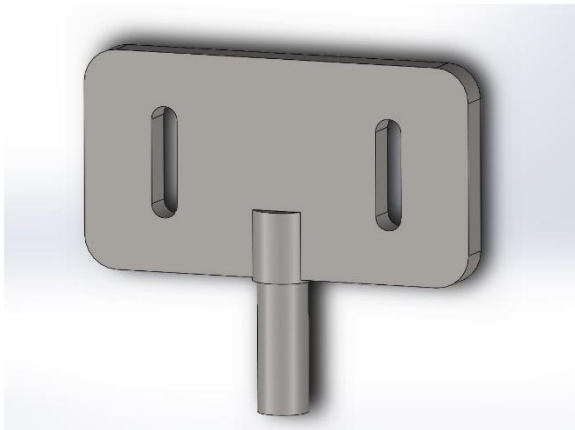
Ilustración 20. Pieza al cual irá anclada la tableta con su otro soporte.
