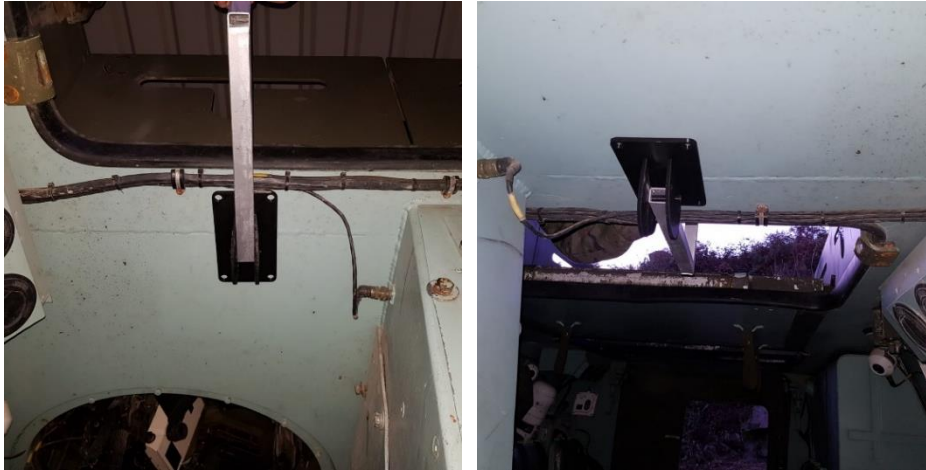
Ilustración 27. Detalle del asentamiento de la base del soporte con el brazo en posición jefe de vehículo.
