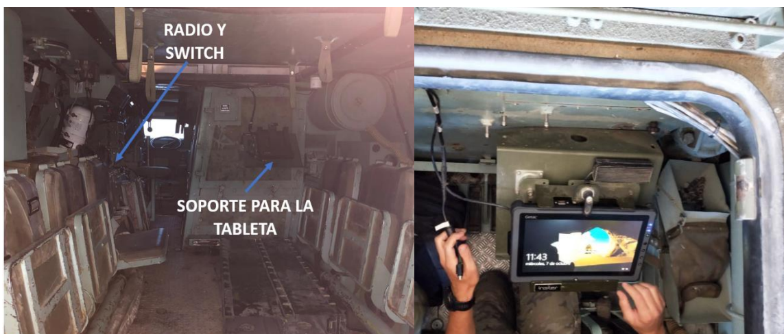
Ilustración 15. Visión general (izquierda) y detalle de la colocación del soporte (derecha) para la tableta en un BMR del BZ II.
