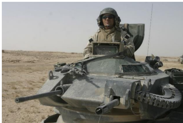
Figura 4: Torreta del AAVP-7A1, equipada con una ametralladora pesada M2HB calibre .50, y un Mk19 lanzagranadas automático de 40 mm. Fuente: [10]
