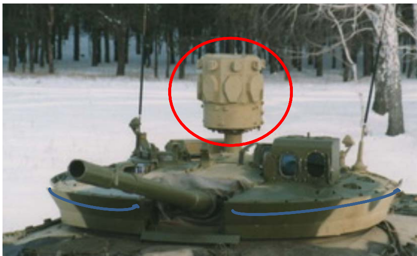
Figura 7. APS Arena original, radar señalado en rojo y contramedidas en azul. Fuente: kbm.ru .
