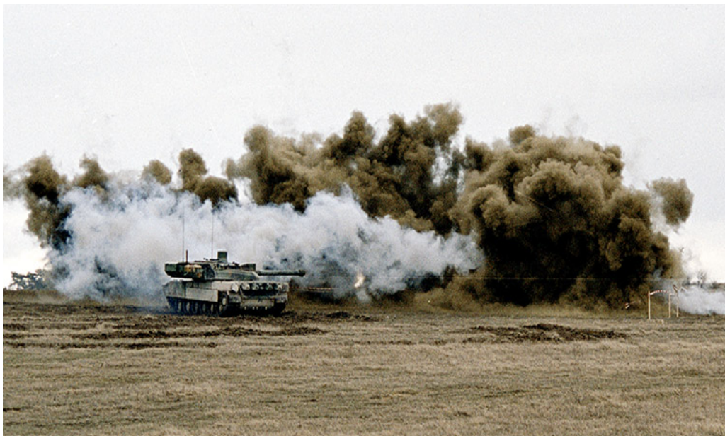
Figura 14. Apantallamiento de un CC provocado por el APS Galix. Fuente: lacroix-defence.com .
