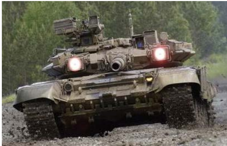
Figura 17. Emisores IR del APS Shtora-1 en funcionamiento. Fuente: militaryleak.com .
