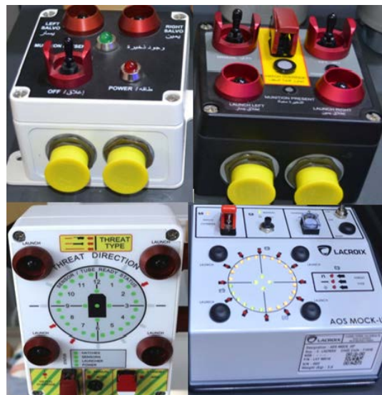
Figura 1. Paneles de control del APS GALIX, Imagen superior BASCU, imagen inferior izquierda FASCU, imagen inferior derecha GALIX 360. Fuente: defence24.com .
