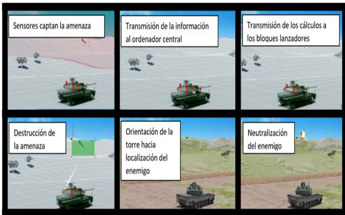
Figura 23. Explicación esquemática del funcionamiento del APS AKKOR. Fuente: imágenes extraídas de youtube.com .
