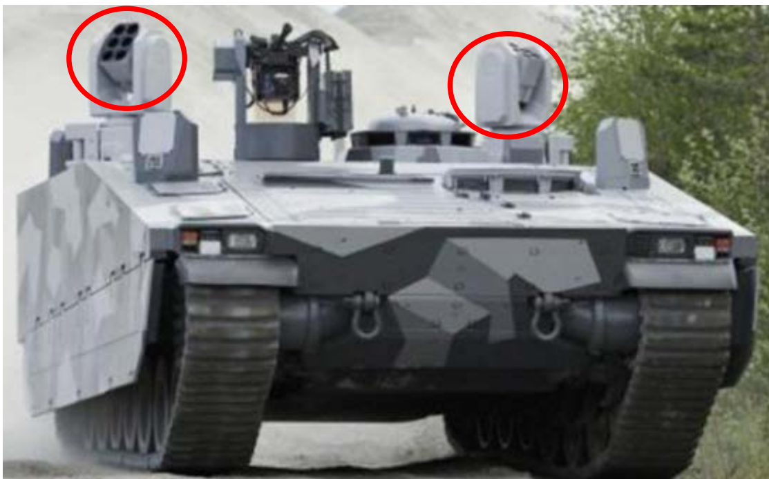
Figura 29. APS LEDS 150 sobre un blindado CV90, señalado en rojo los bloques lanza-ingenios del APS. Fuente: revistaejercitos.com .
