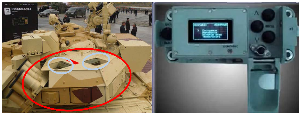
Figura 8. Izquierda, uno de los dos módulos (señalado en rojo) de contramedidas (señaladas en azul), a la derecha el panel de control. Fuente: defence-update.com , youtube.com , editado por el autor.
