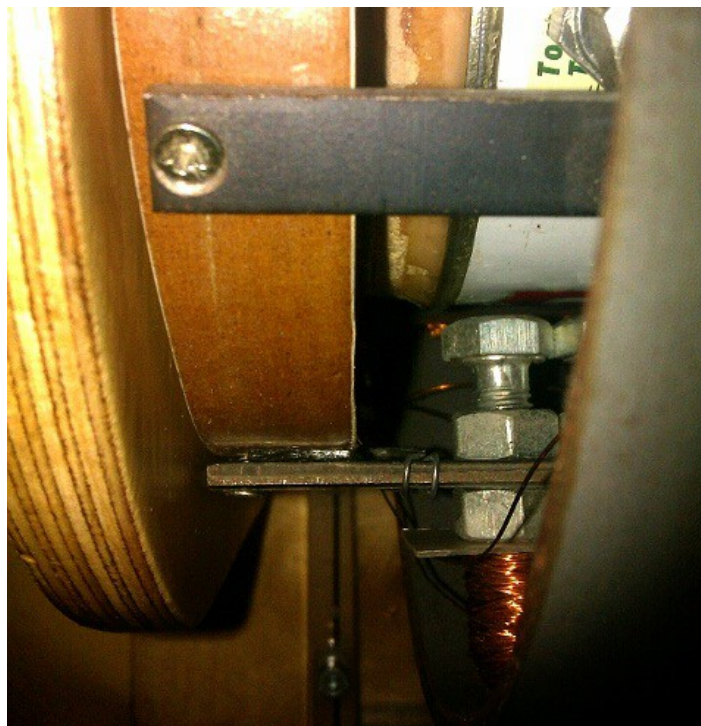
Figura 36. Lámina de plástico para eliminar el rozamiento.
