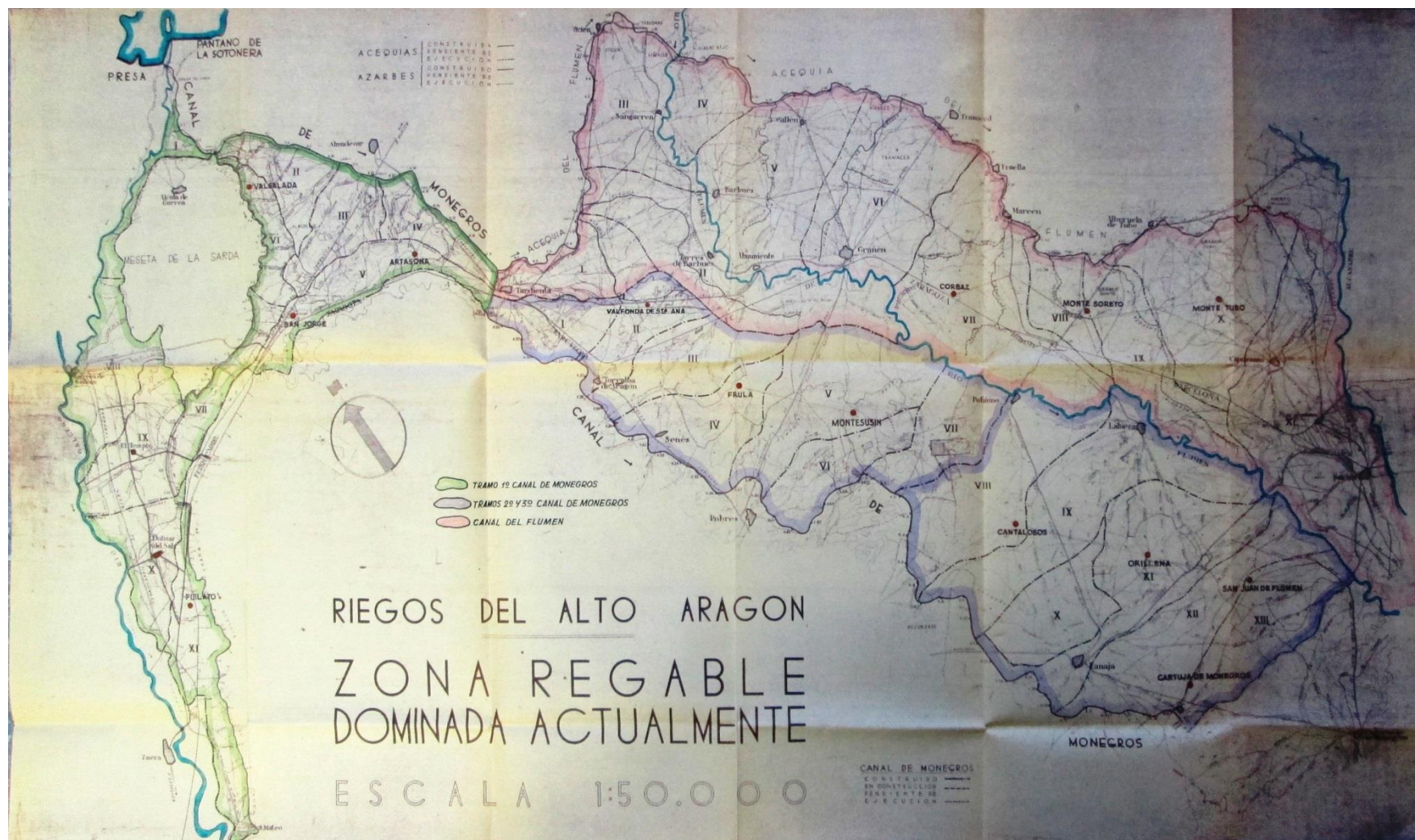
Fig. 8. Plano correspondiente a las zonas regables del Canal de Monegros. El área de la izquierda, en forma de cuña, corresponde a la zona regable del primer tramo del Canal de Monegros y la acequia de La Violada. El área de la derecha corresponde a la zona regable Monegros-Flumen, en concreto a los tramos segundo y tercero del Canal de Monegros, que discurre por la parte inferior, y a la acequia del Flumen, que discurre por la parte superior; como se puede apreciar, el río Flumen atraviesa esta zona por su centro. Fuente ACMA (proyecto nº 10021)
