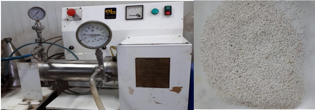
Figura 20. Molino fase líquida y bolas de relleno que hay en su interior
