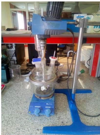
Figura 18. Reactor de cristal, con agitador de teflón
