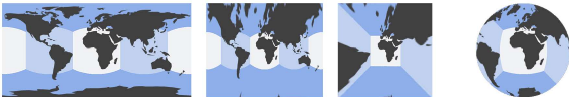
Figura 2.5: Tipos más comunes de proyecciones, en orden: Esférica, cilíndrica, rectilínea y ojo de pez
