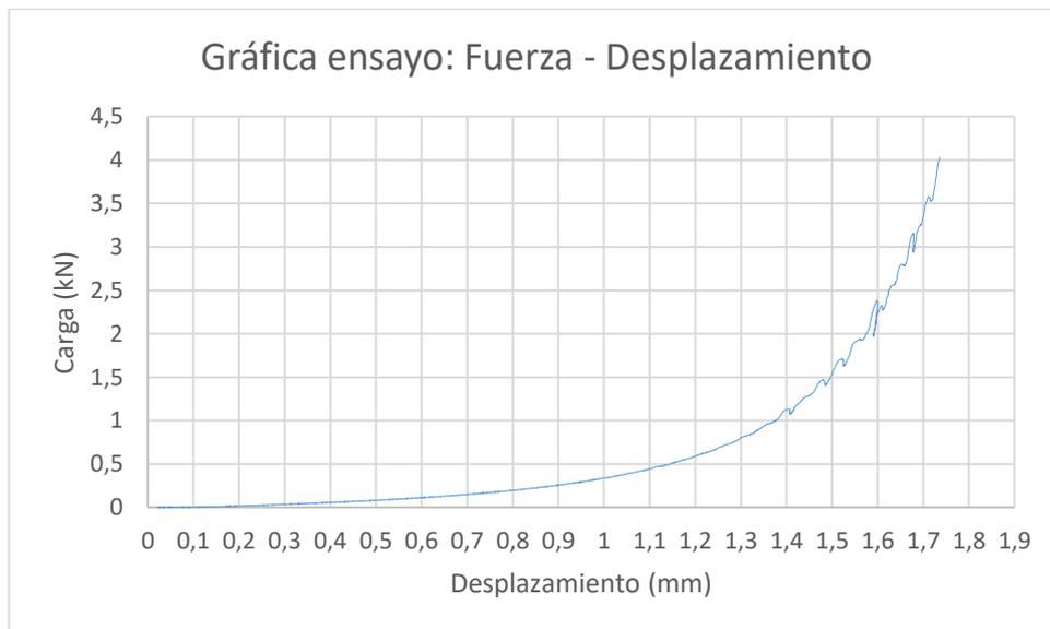
Como se puede observar, la fuerza aumenta de una manera exponencial con el desplazamiento. La longitud del ensayo es de 1.7mm aproximadamente, que supone un 70% de compresión en la sección de la junta tórica.
