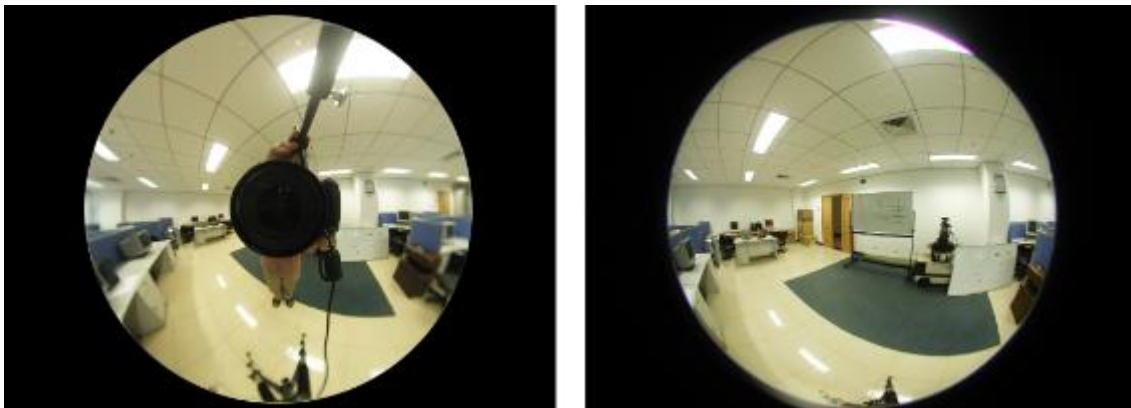
Figura 1.4 Imagen tomada con una cámara catadióptrica central a la derecha e imagen tomada con cámara de ojo de pez a la izquierda [11]
