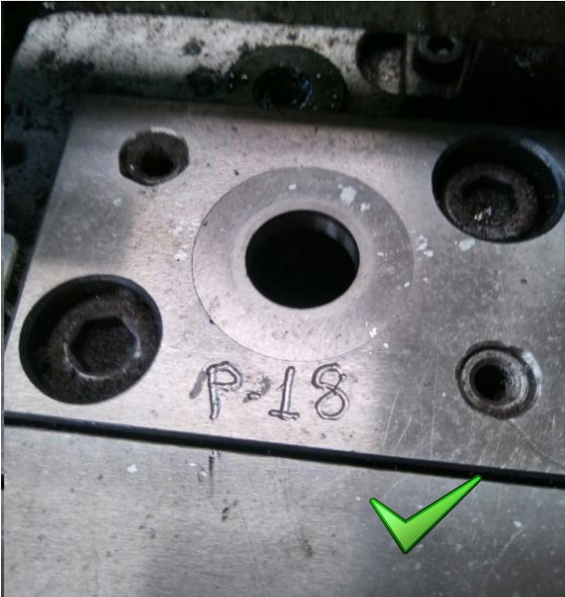
COMPROBAR HUNDIMIENTOS EN LA CARA DE CORTE DEL CASQUILLO, CANTOS POCO
